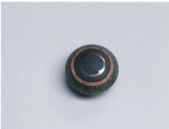
Wachstumszelle aus Speziallegierung in die die aufbereitete Asche eingefüllt wird.
